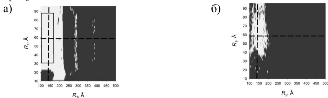
Рис. Контурные графики устойчивости восстановления решения в зависимости от стартовых значений радиусов сферических частиц кремнезоля ( R_1 , R_2 )
